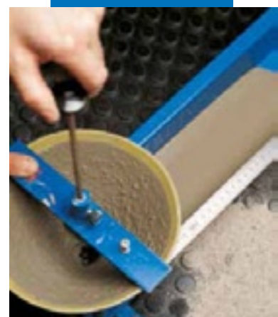
Испытание расширения в канавке согласно норме UNI 8997/89
